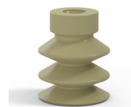
Variantenreferenz: 21 18CN A • Farbe: Braun • Materiale: Naturkautschuk • Shore-Härte: SH35
