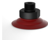
Variantenreferenz: 90 30SL M18 • Farbe: Rot (Lebensmittels zertifikat) • Materiale: Silikon • Shore-Härte: SH60
