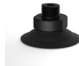
Variantenreferenz: 90 30NI M18 • Farbe: Schwarz • Materiale: Nitril • Shore-Härte: SH50
