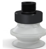
Variantenreferenz: 91 20TPU M18 • Farbe: Transluzent • Materiale: Thermoplastisch • Shore-Härte: SH60
