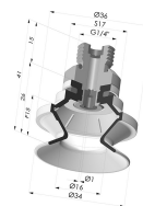
Sauggreifer 1.5 Falten Serie 91 Ø 34MM
