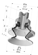
Sauggreifer 1.5 Falten Serie 91 Ø 34MM
