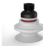
Variantenreferenz: 91 31SLT 14D-2 • Farbe: Transluzent (Lebensmittels zertifikat) • Materiale: Silikon • Shore-Härte: SH60
