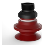
Variantenreferenz: 91 31SL 38D-2 • Farbe: Rot (Lebensmittels zertifikat) • Materiale: Silikon • Shore-Härte: SH60
