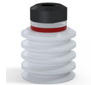
Variantenreferenz: 92 30SLT 18D-2-F • Farbe: Transluzent (Lebensmittels zertifikat) • Materiale: Silikon • Shore-Härte: SH60
