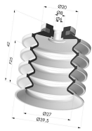
Sauggreifer 4.5 Falten Serie 92 Ø 40MM
