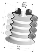
Sauggreifer 4.5 Falten Serie 92 Ø 50MM
