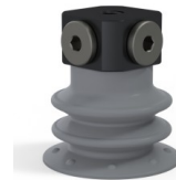
Variantenreferenz: 96 25NR FM5BD • Farbe: Grau • Materiale: Naturkautschuk • Shore-Härte: SH50
