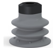
Variantenreferenz: 96 35NR 18D-2 • Farbe: Grau • Materiale: Naturkautschuk • Shore-Härte: SH50
