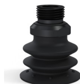
Variantenreferenz: 96 35NI 38D-2-F • Farbe: Schwarz • Materiale: Nitril • Shore-Härte: SH50
