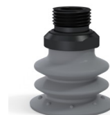
Variantenreferenz: 96 35NR 38D-2-F • Farbe: Grau • Materiale: Naturkautschuk • Shore-Härte: SH50
