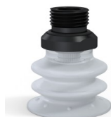
Variantenreferenz: 96 35SLT 38D-2-F • Farbe: Transluzent (Lebensmittels zertifikat) • Materiale: Silikon • Shore-Härte: SH60
