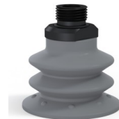
Variantenreferenz: 96 52NR 38D-2-GIC • Farbe: Grau • Materiale: Naturkautschuk • Shore-Härte: SH50
