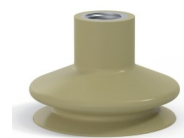
Référence déclinaison : 8A 50CN F14 • Couleur: Marron certification alimentaire FDA • Dureté Shore: SH35 • Matière: Caoutchouc naturel
