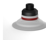
Référence déclinaison : 9 40SLT M18D-4 • Couleur: Translucide certification alimentaire CE • Dureté Shore: SH60 • Matière: Silicone
