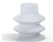
Référence déclinaison : 2 30SLT A • Couleur: Translucide certification alimentaire CE • Dureté Shore: SH60 • Matière: Silicone
