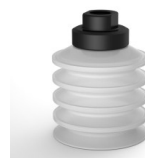
Référence déclinaison : 92 40SLT F18 • Couleur: Translucide certification alimentaire CE • Dureté Shore: SH60 • Matière: Silicone
