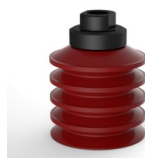
Référence déclinaison : 92 40SL F18 • Couleur: Rouge certification alimentaire CE • Dureté Shore: SH60 • Matière: Silicone
