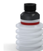
Référence déclinaison : 92 30SLT 14D-2-F • Couleur: Translucide certification alimentaire CE • Dureté Shore: SH60 • Matière: Silicone
