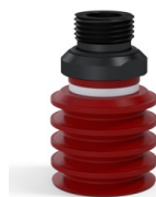
Référence déclinaison : 92 30SL 38D-2-F • Couleur: Rouge certification alimentaire CE • Dureté Shore: SH60 • Matière: Silicone
