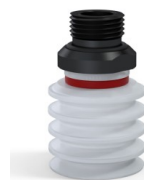
Référence déclinaison : 92 30SLT 38D-2-F • Couleur: Translucide certification alimentaire CE • Dureté Shore: SH60 • Matière: Silicone
