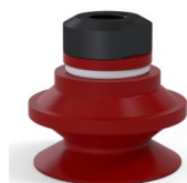
Riferimento variante: 91 31SL 18D-2 • Colore: Rosso Certificato alimentare CE • Durezza Shore: SH 60 • Materiale: Silicone
