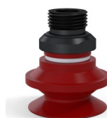
Riferimento variante: 91 31SL 38D-2-F • Colore: Rosso Certificato alimentare CE • Durezza Shore: SH 60 • Materiale: Silicone
