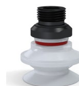
Riferimento variante: 91 31SLT 38D-2-F • Colore: Trasparente Certificato alimentare CE • Durezza Shore: SH 60 • Materiale: Silicone
